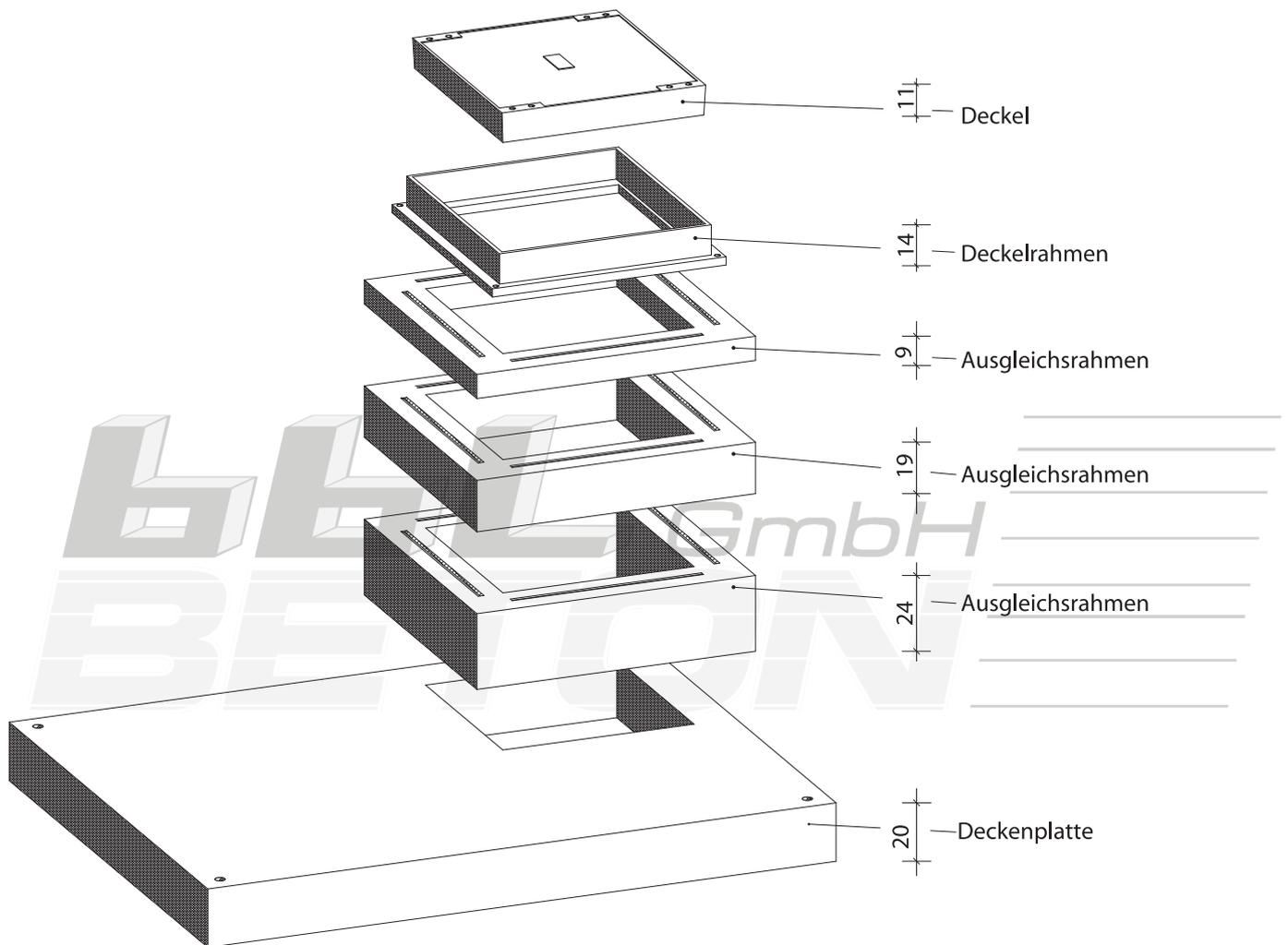
Ausgleichsrahmen dienen zum Höhenausgleich zwischen Schachtdecke und Schachtabdeckung für alle Deckenplatten mit Einstiegsöffnungen 70/70 cm und 140/70 cm. Sie sind in verschiedenen Standardbauhöhen lieferbar.
